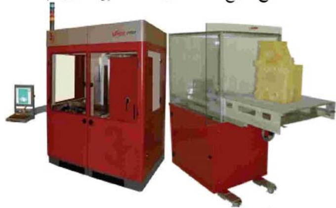
صورة رقم (3/2) ماكينات الطباعة المجسمة Stereolithography لعمل النماذج، (المصدر : http://www.3dsystems.com/default.asp (Accessed 6/7/2006))
