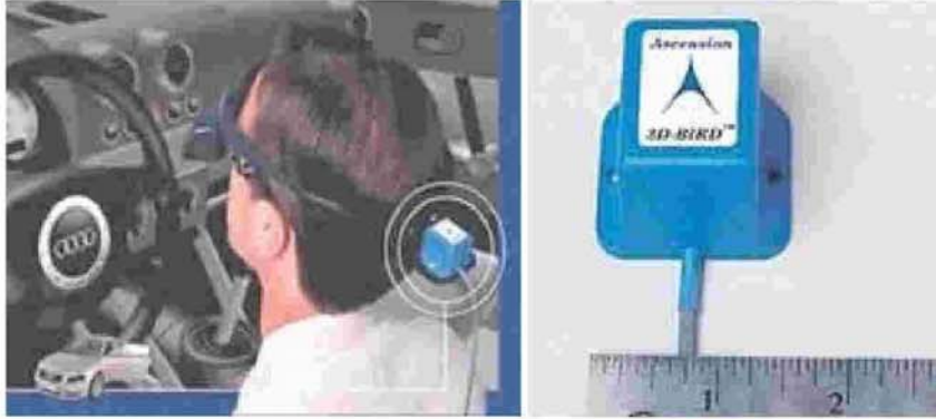
صورة رقم (16/6) جهاز تتبع الحركة خفيف الوزن، ويظهر مكان تركيبه و في الصورة الأخرى أبعاده و حجمه.
