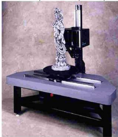
صورة رقم (16/2) توضح جهاز المسح بالليزر Laser للأشكال المعقدة ذات التفاصيل الدقيقة، (المصدر : http://www.cyberware.com/products/scanners/index.html (Accessed 6/7/2006))
