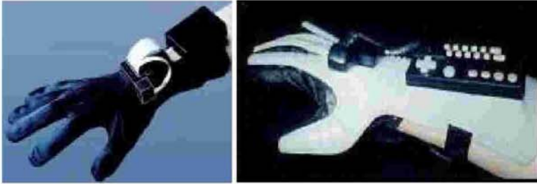
صورة (13/6) أنواع مختلفة من قفازات البيانات تسمح بالتحكم والقبض والإحساس باللمس، (المصدر: أحمد وحيد مصطفى: (2005)، "التصميم والواقع الافتراضي"، مرجع سابق.)
